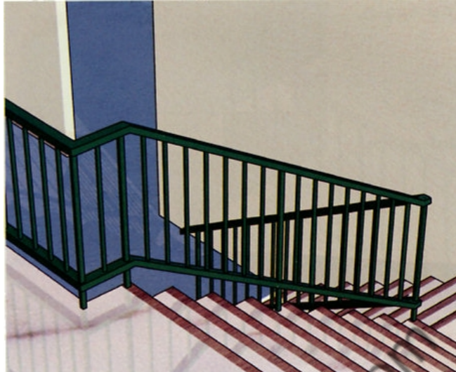
Figure 6.29 : Garde-corps dans un escalier
