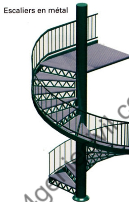
Figure 6.23 : Marches en console pour escalier hélicoïdal
