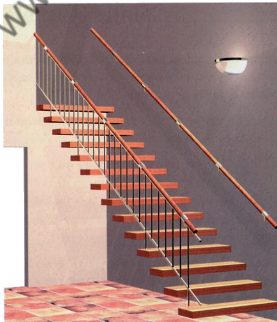
Figure 6.22 : Marches en console sur mur
